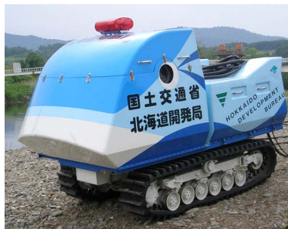
写真-2 既存ポンプ自走装置
