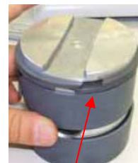
写真-12 ピストンリング取付状況
