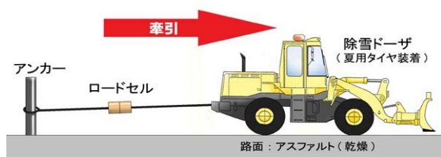
図-2 牽引力試験概要図
