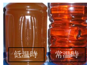
写真-1 始動不能時の燃料フィルター及び燃料の状態
