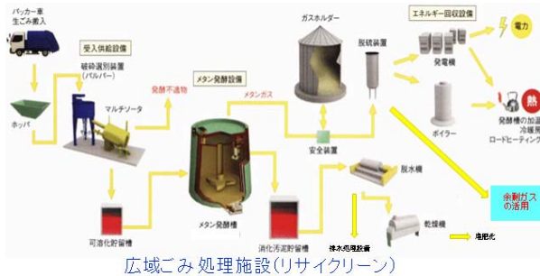
図-5 高速メタン発酵処理施設(滝川市、リサイクル)
