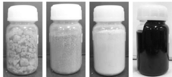
(a)粗骨材 (b)細骨材 (c)石粉 (d)ストレートアスファルト
