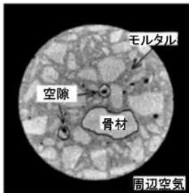
(a) セメントコンクリートのX線CT画像
