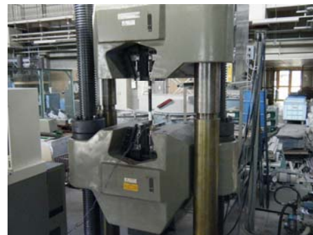
写真-2 引張り試験状況
