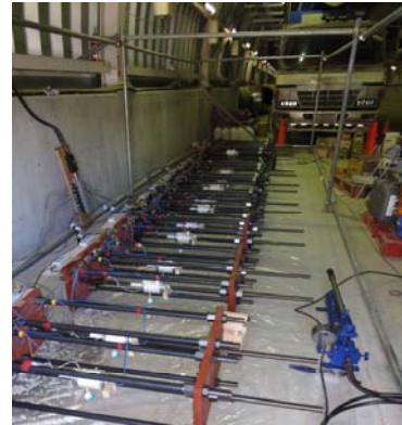
写真-1 腐食試験体作製状況
