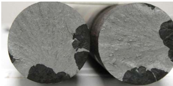
写真-4 PC鋼棒の破断面画像
