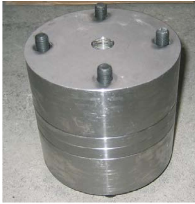
図-2.7 スリット注入試験装置
