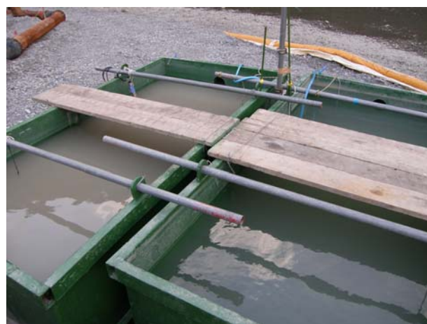
写真-14 静置 3 時間後の水槽 1 (右手前) と水槽 2 (左奥)
