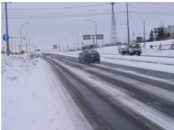
写真-3 冬期走行試験(路面：凍結)
