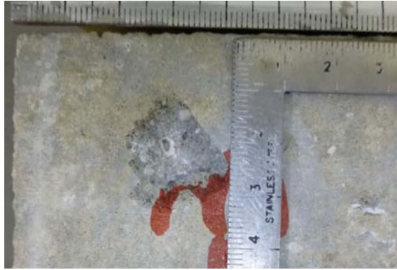
図-2.14 はく離の状況 (JA, アルカリ量 2.2\text{kg/m}^3 )
