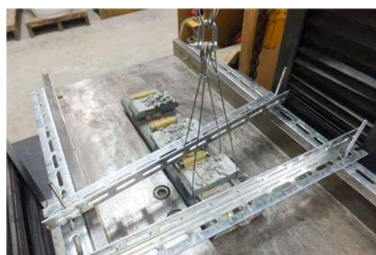
写真-2.17 引張接着試験の状況
