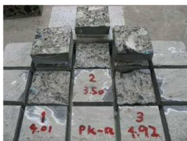
写真-4.1 付着強度試験の破壊面
