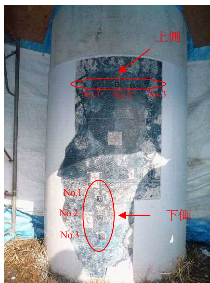
写真-4.11 引張付着性試験位置
