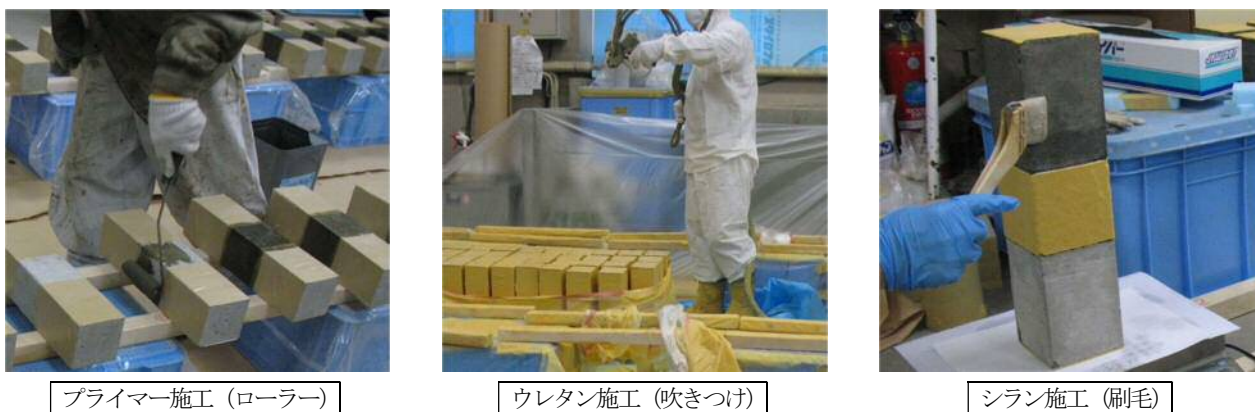
写真-3.14 供試体作製の様子 (シラン施工の写真は、供試体Ⅲのもの)
