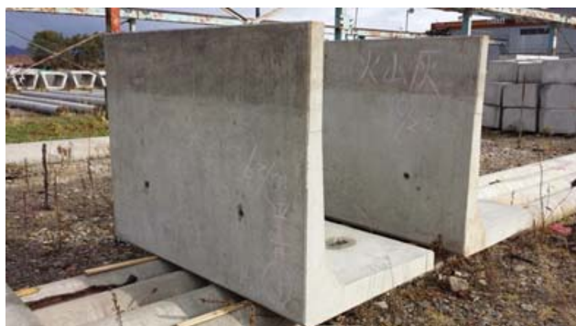
写真-5 脱型後の製品の状況
