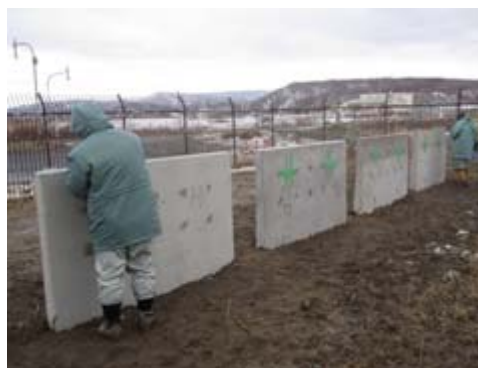
写真-5 暴露状況および非破壊検査状況
