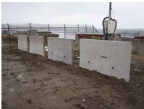
写真-5 暴露状況および非破壊検査状況
