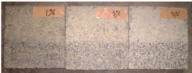
* 上部：汚れの再現前 下部：汚れの再現後 写真-5 測定に使用した供試体
