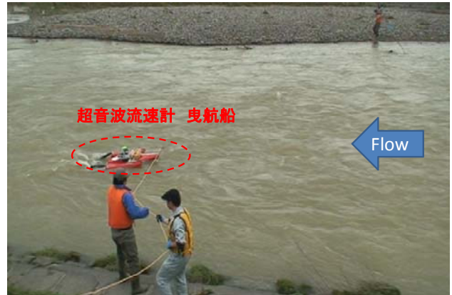
写真-1 超音波流速計の曳航船による河道内流況観測 (A 川 KP11.76 付近)
