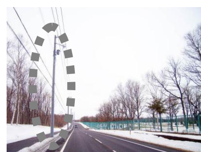
写真-3 郊外部において歩車道境界付近に電柱が設置された事例
