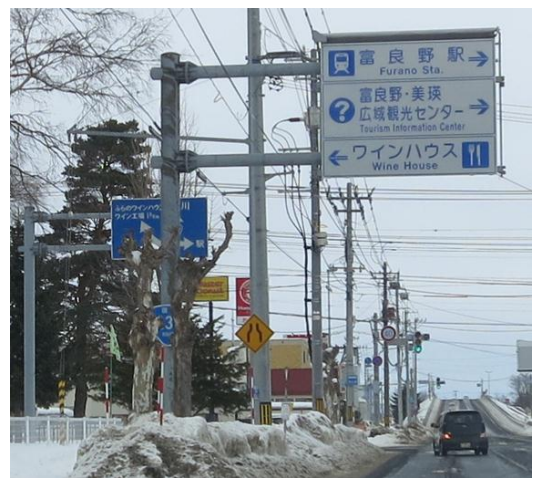
写真-7 標識が隠れている事例
