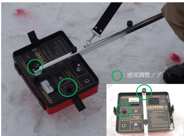
写真-10 金属探知機の感度調整 ※写真の2つのノブを細かく操作し感度を調整
