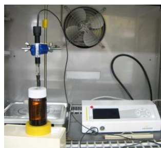
写真1 N 2 O マイクロセンサーによる連続測定の実景
