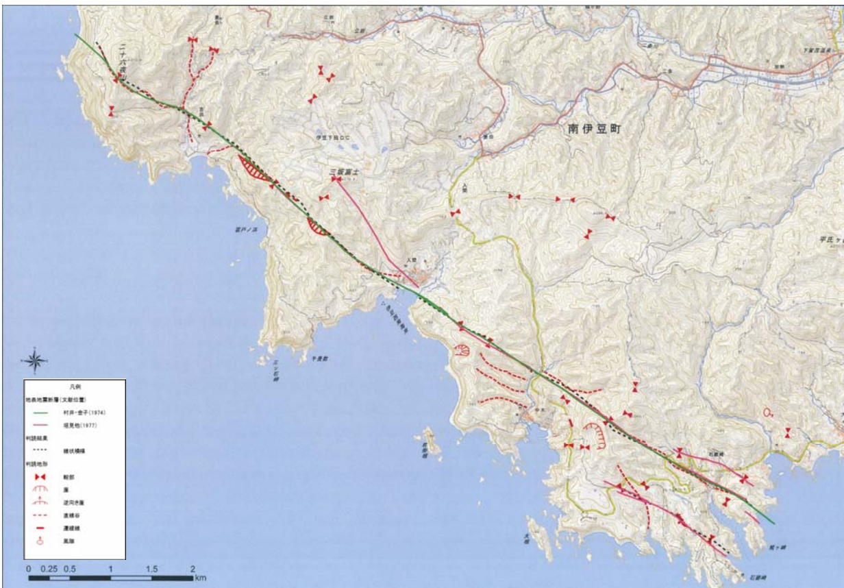
図-4 地形判読結果の例(伊豆半島沖地震 石廊崎中央断層 地表地震断層位置は文献 4),5) より
