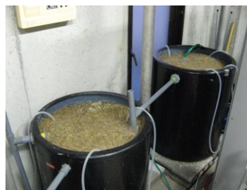
写真-4 担体処理反応槽
