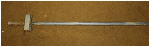
図33 室内引抜き試験用のアンカー補強材
