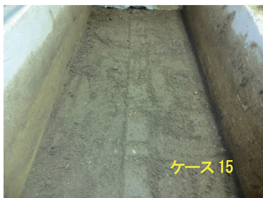
図 26 引抜き試験後のストリップ設置面の状態
