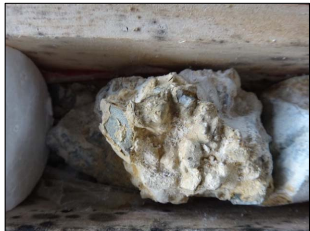
図-12 坑壁背部のコアの溶食
