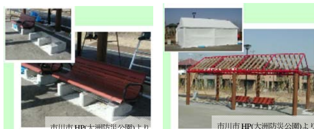
写真-11 左：平時はベンチとして使用するかまどベンチ 右：災害時にはテントを設置することで避難場所などとして活用するパーゴラ
