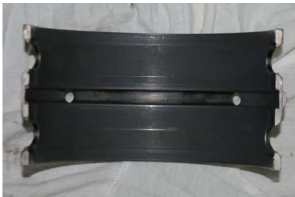
写真-21 N排水機場原動機 クランクピンメタル
