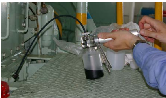
写真-25 専用ポンプによるサンプリング
