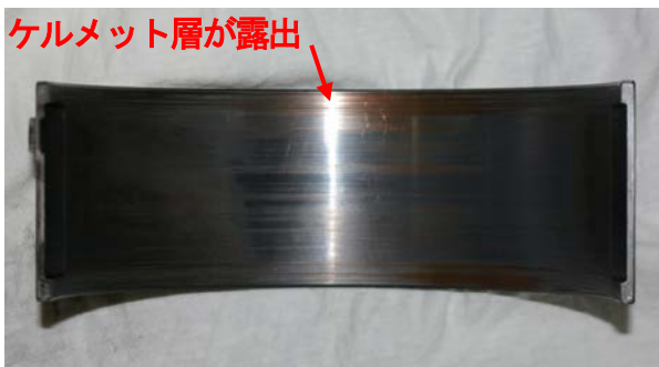
写真-20 H排水機場原動機 クランクピンメタル
