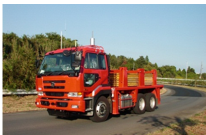
写真-9 耐久性試験に用いた無人荷重車
