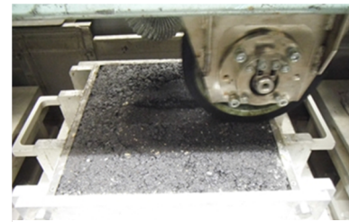
写真-11 走行試験状況
