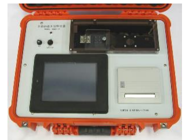
図-11 貫入式間隙水圧計（4m）
