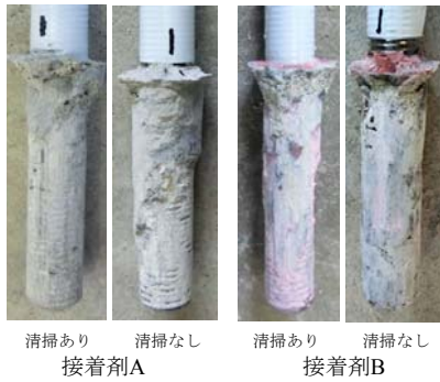
図-16 試験後の破壊状況の例
