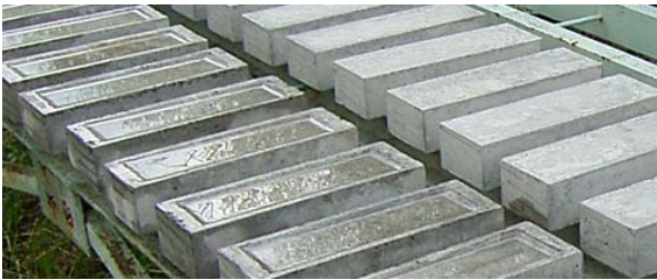
図-1 凍結融解の暴露試験の状況
