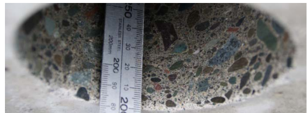
写真-5.1.8 コア採取後の孔穴 (表面近傍に吸水防止層が見える)
