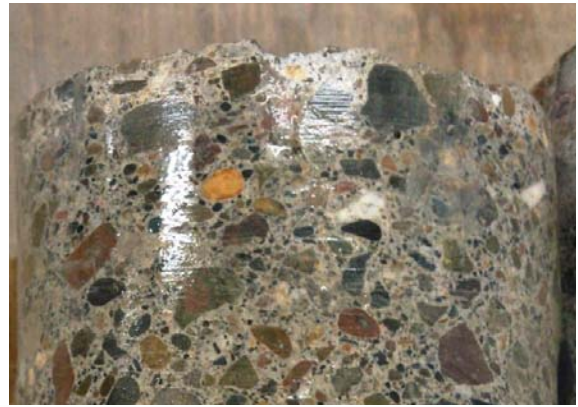
写真-5.1.6 塗布後10年目の美幌の地覆から採取したコアの側面に水を噴霧した様子（表面付近に吸水防止層が見える）
