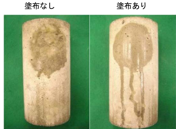
写真-4.2.1 水を噴霧した後の供試体の外観 (10年目)
