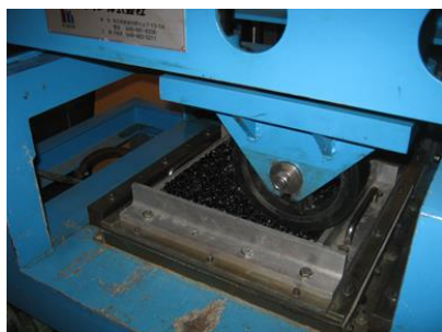
写真-13 トラバース試験状況
