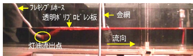
図-14 開水時の灯油流出状況（側面より撮影，case3）
