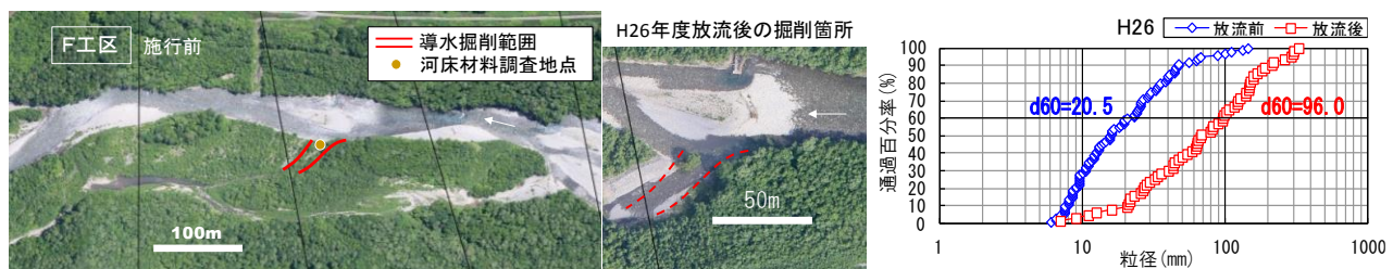
図-10 H26年度 F工区掘削箇所の概要と河床材料の粒度分布の変化
