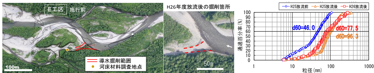
図-8 H25年度 E工区掘削箇所の概要と河床材料の粒度分布の変化
