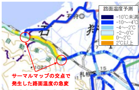
図-1 サーマルマップの繋ぎ目で発生する温度ギャップ
