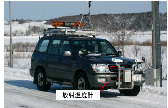
図-5 サーマルマップの調査状況
