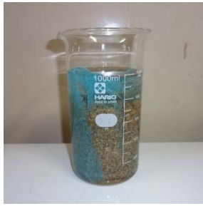
写真3 酸性水浸漬試験の状況（火山礫の例）
