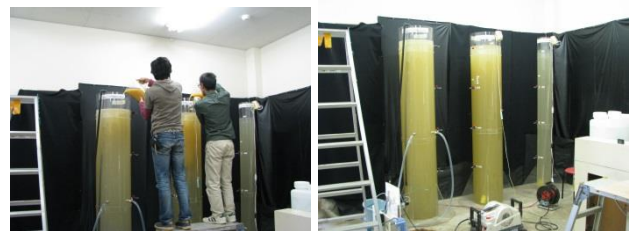
アロフェン投入の様子 濁水攪拌の様子
