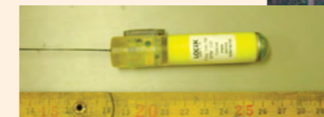
■装着電波発信機 LOTEK社MBFT-7A 重量29g
