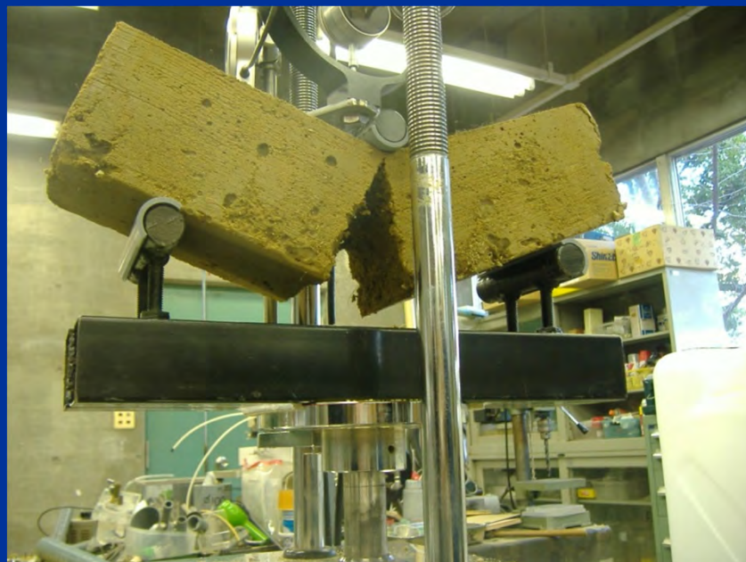
曲げ強度試験状況
