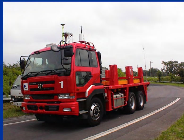
促進載荷に用いた荷重車
