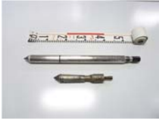
電気式コーン(上)と機械式コーン(下)
