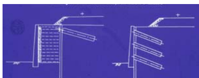
1995年阪神淡路大地震： JR神戸線摂津本山～住吉間の盛土山側の崩壊したのり面のジオテキスタイル補強土擁壁と太径地山補強土工法による強化復旧 (1995年6月13日内村太郎氏撮影)
