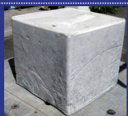
塩化ナトリウムを混入量を変えたコンクリートブロック
