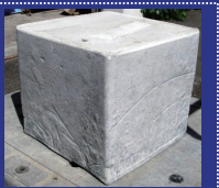
塩化ナトリウムを混入したコンクリートブロック
