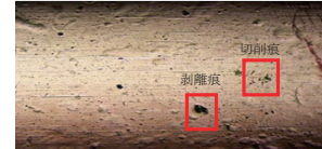
内輪部の光学顕微鏡写真
