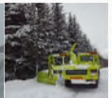
▲マックレーによる堆雪の“かき出し”作業
