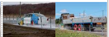
分離帯用A種の衝突試験の状況 (2016年3月, 8月)
