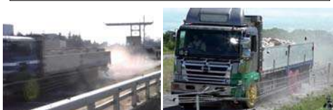
H23 ロープ連結材なし H28 ロープ連結材あり 前輪タイヤのロープ押し下げ (3本から1本に) 防止に有効 最大進入行程: 1.48mから0.985mに低下 (※張力12kNの衝突実験においても0.95mを記録)
