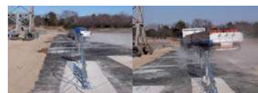
分離帯用A種の衝突試験の状況(2012年1月)
