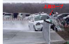
H28 ロープ連結材あり 最大進入行程: 1.05mから0.94mに低下し、上段ロープの押し上げ防止に効果を発揮
