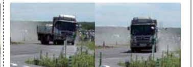
大型車の防護柵衝突後の軌跡 (2016年3月, 8月)
