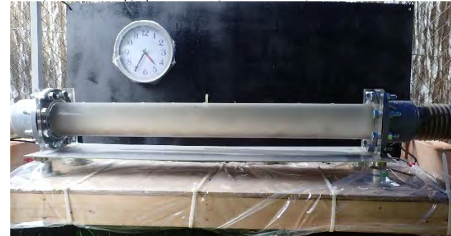
土砂濃度計測装置(自動化)
