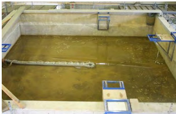
①水槽内に0.1~2mmの混合砂を敷き詰め、排砂管を堆砂表面に設置
