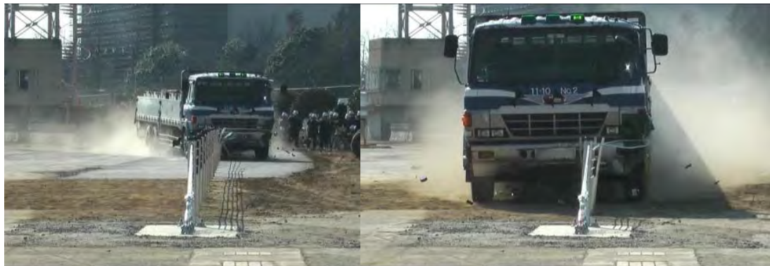
大型車の防護柵衝突後の軌跡(2012年1月)
