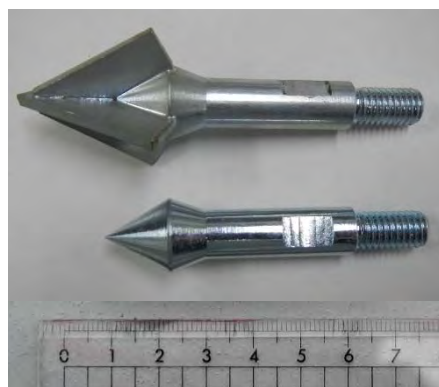
土層強度検査棒（どけん棒）の構成
