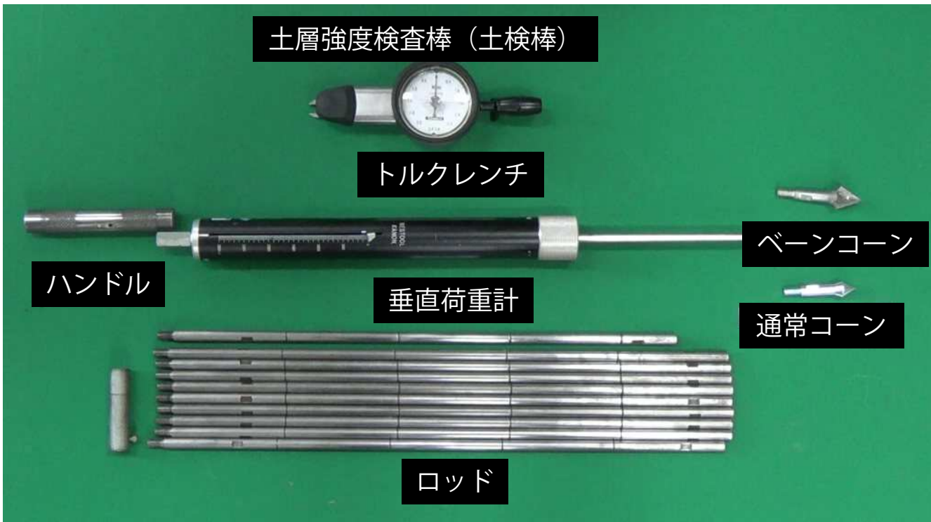
土層強度検査棒（どけん棒）の構成
