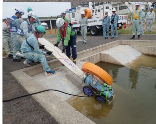
排水ポンプ車 排水ポンプの組立・投入・排水訓練
