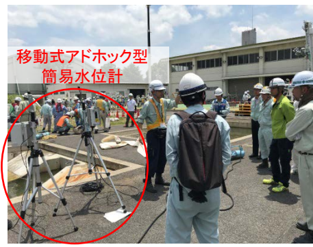
移動式アドホック型簡易水位計の実演
