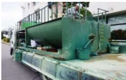
吹付工用ポンプ車
