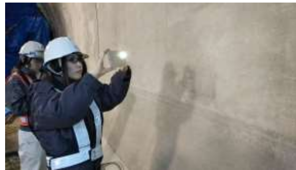
コンクリート表層品質のAI画像診断
