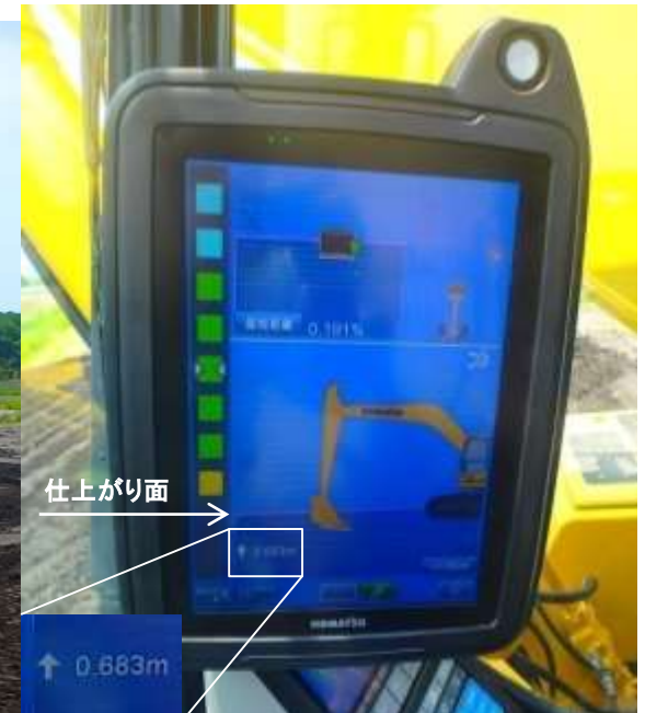
【ICT建機のバックホウの液晶画面】 画面に施工目標と自機の状態表示を行っている。
