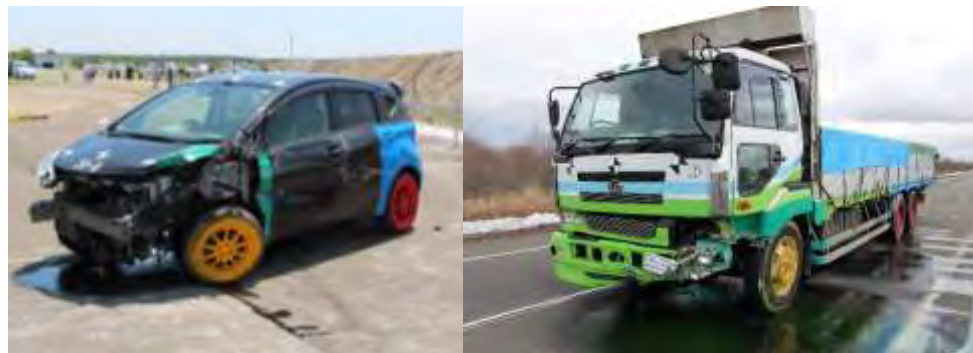
衝突後の乗用車と大型車の破損状況(2020年7月, 3月)
