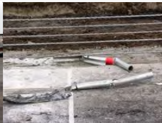
性能確認試験後の状況(平成28年3月): 支柱が抜ける
