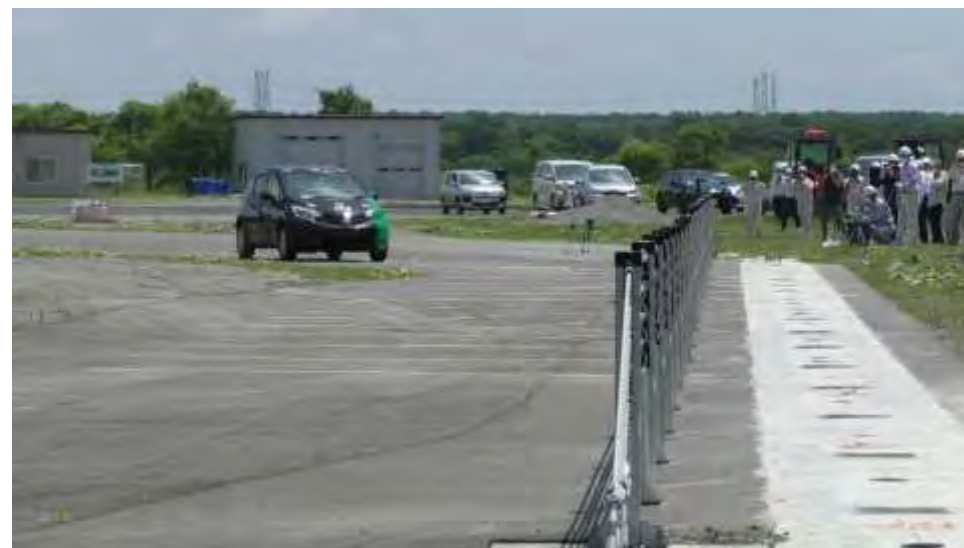
分離帯用Am種の衝突試験の状況(2020年7月)
