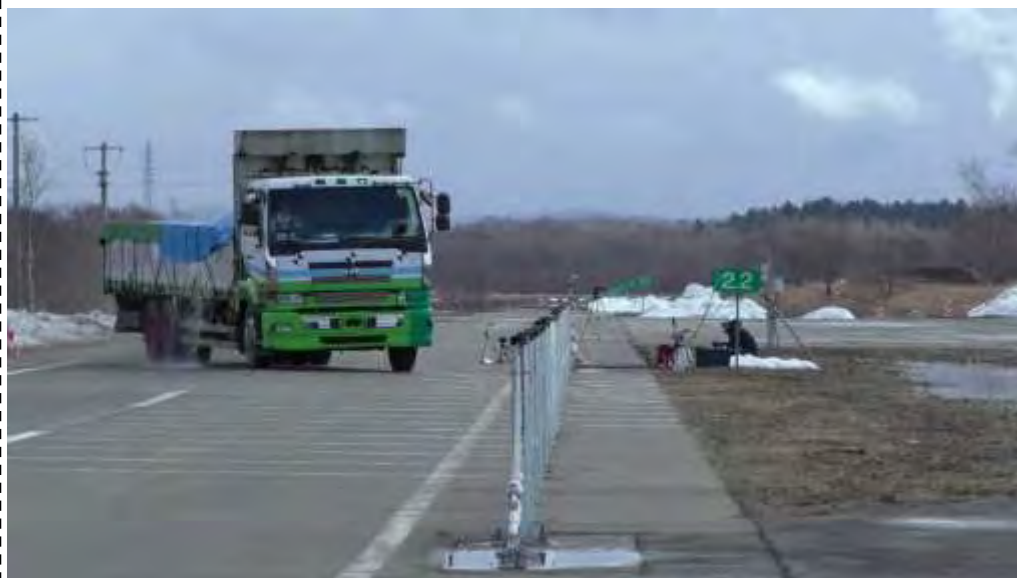
分離帯用Am種の衝突試験の状況(2019年3月)
