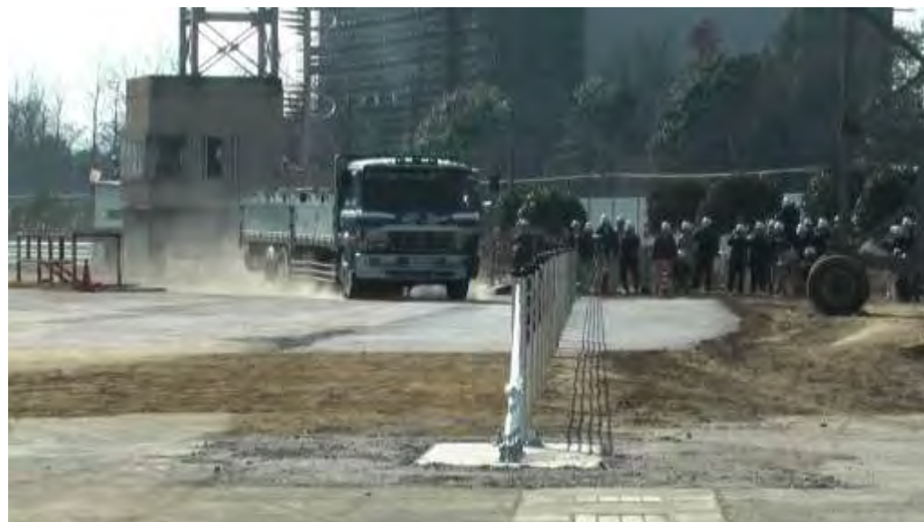
分離帯用Am種の衝突試験の状況(2012年1月)
