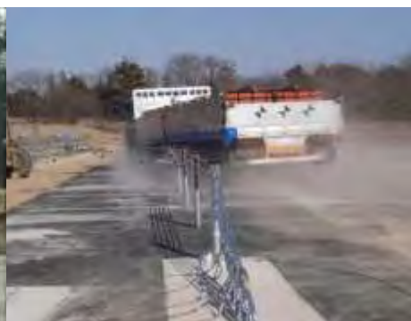
分離帯用Am種の衝突試験の状況(2012年1月)
