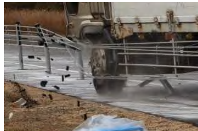
下段のロープが車体下部に巻き込まれることを防ぎ、できるだけ多くのロープが車体を捉える
