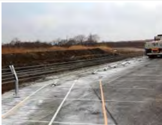
性能確認試験後の状況(平成28年3月): 支柱が抜ける
