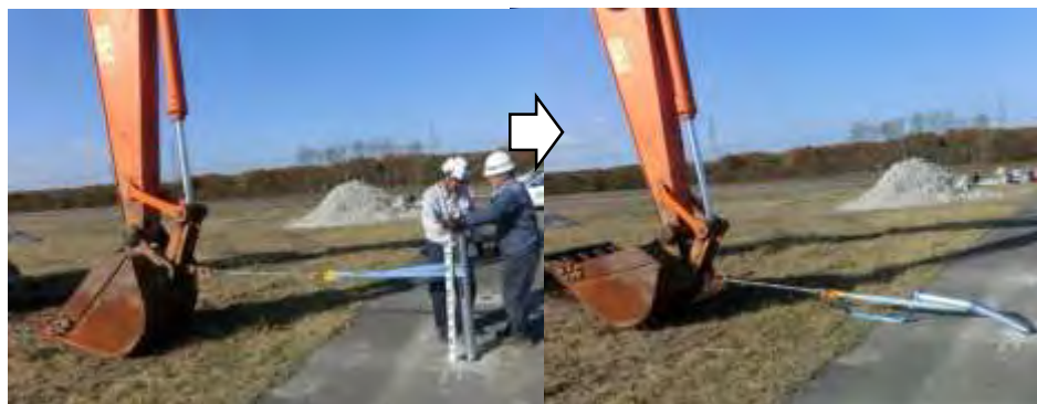
下部切欠き付き支柱引き抜き試験
