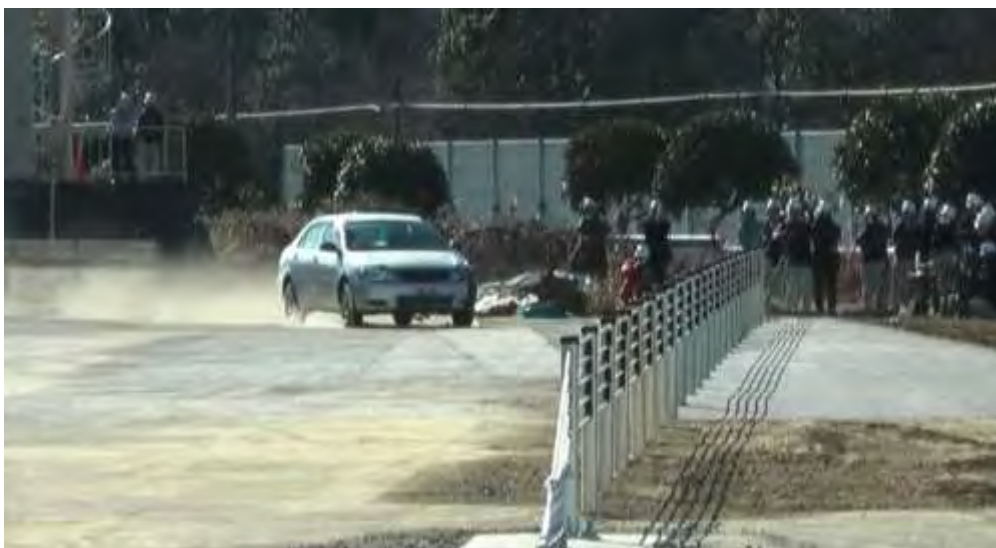
分離帯用Am種の衝突試験の状況(2012年1月)
